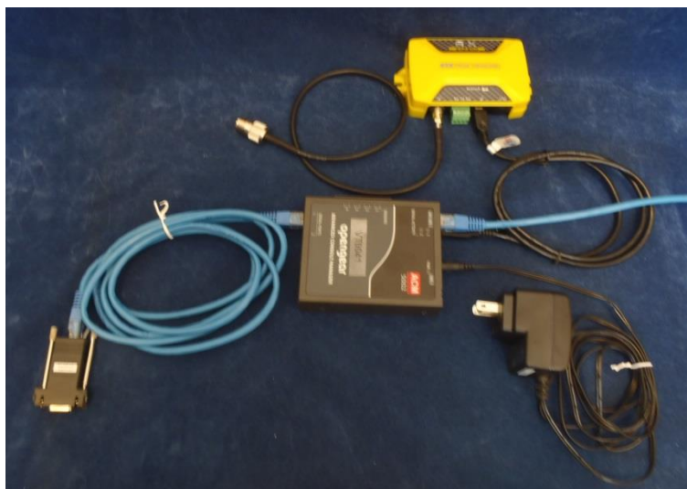
AIS 受信機 ケーブル付 miniPC (転送サーバ) ケーブル付
